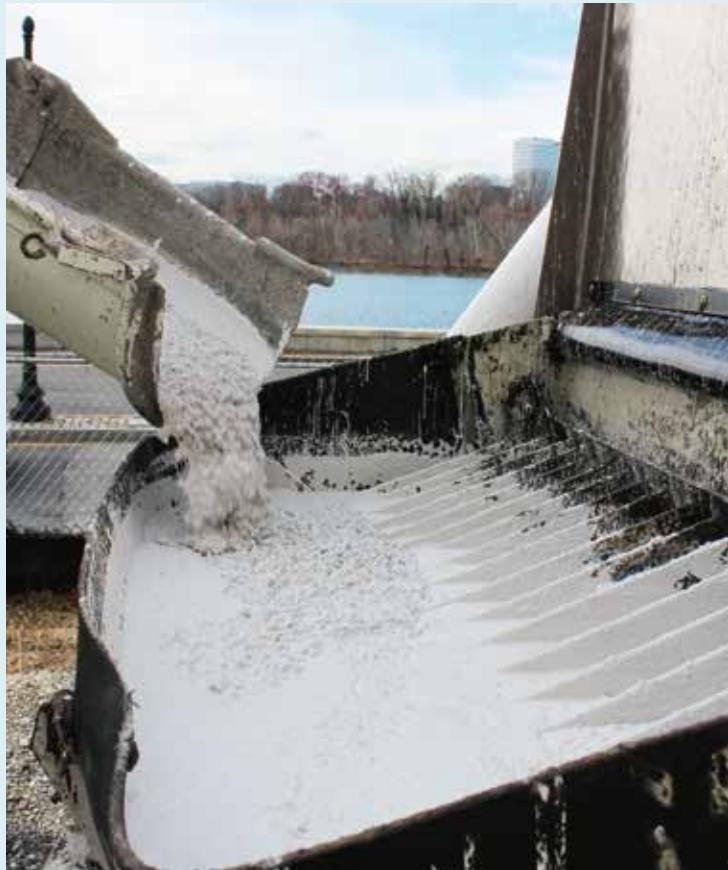
阿尔博®白水泥的化学特性非常适合与混凝土外添加剂充分地相互作用,以提供出色的流动性和可预测的结果。这种流动性使混凝土能够真实地还原复杂的形状和不同的纹理,比如褶皱金属的光滑纹理或木材的粗糙纹理。不同的混凝土表面产生不同的表达意图;这种双重性使得建筑物具有更吸引人的建筑细节、生动有趣。
